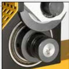
**Dispositivo per scanalare REMS – compatto – universale. Avanzamento del rullo di pressione con cilindro oleoidraulico.**
